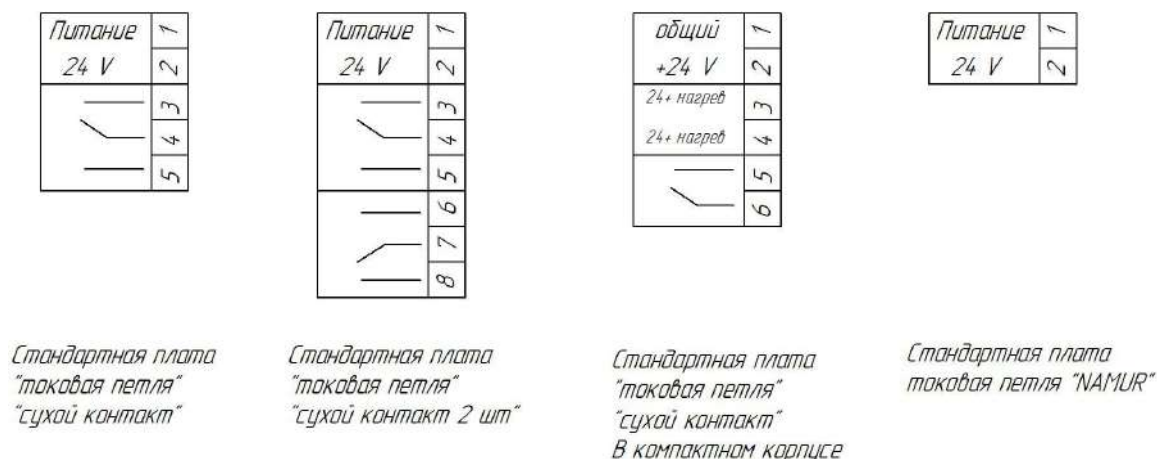
Рис.5 Виды контактных групп для сигнализатора уровня СЖУ-1-ВБ
